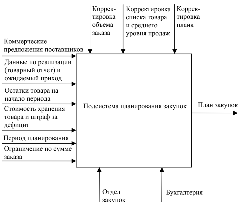
Рис. 25. Функциональная диаграмма подсистемы планирования закупок
